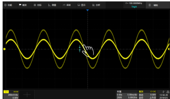
通过垂直方向的两点缩放手势控制波形的垂直档位。当多个通道打开时，控制的是波形离触摸区域最近的通道
